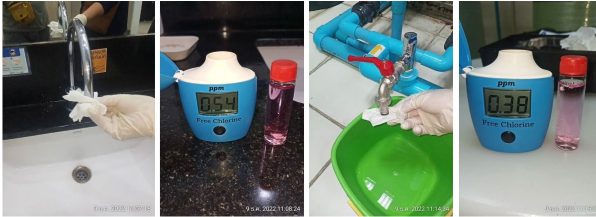
รูปที่ 2-24 การทำความสะอาดจุดจ่ายน้ำและวัดค่าน้ำ
